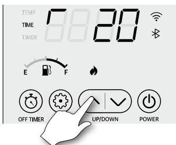
4. Die Betriebszeit kann zwischen 10 und 55 Minuten eingestellt werden, oder das Heizgerät kann auf Dauerbetrieb eingestellt werden. Nach Beendigung des Betriebszyklus unterbricht das Heizgerät den Betrieb immer für fünf (5) Minuten. Auf dem Display werden neben der Betriebszeit zwei Striche (-) angezeigt, um die Pause anzuzeigen.
