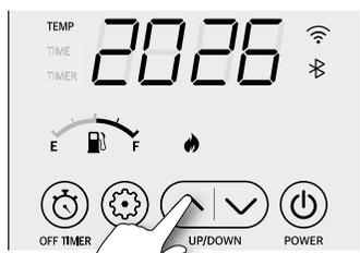
4. Nach dem Einschalten wird das Heizgerät automatisch aktiviert, wenn die Ist-Temperatur um zwei (2°C) Grad unter die Soll-Temperatur fällt. Dementsprechend wird das Heizgerät deaktiviert, wenn die Ist-Temperatur um ein Grad (1°C) über die eingestellte Solltemperatur ansteigt.
