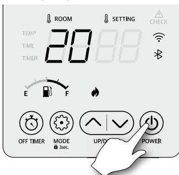
2. Wenn der Thermostatbetrieb ausgewählt ist, leuchtet die entsprechende Signalleuchte. Um vom Thermostatbetrieb in den Timer-Betrieb zu wechseln, drücken Sie Modus-Taste.
