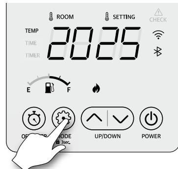
3. Wenn der Timer-Betrieb eingeschaltet ist, wird links ein leuchtender Ring angezeigt. Auf der rechten Seite wird die eingestellte Betriebszeit (in Minuten) angezeigt. Wählen Sie mit den Pfeiltasten die gewünschte Betriebszeit aus. Die ausgewählte Zeit blinkt auf dem Display. Wenn die Pfeiltasten drei (3) Sekunden lang nicht gedrückt werden, wird die auf dem Bildschirm angezeigte Zeiteinstellung aktiviert.
