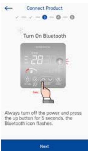
6. Schalten Sie das Heizgerät aus und drücken Sie die Aufwärtstaste 5 Sekunden lang. Anschließend blinkt die Bluetooth-Leuchte. Drücken Sie die Taste NEXT (WEITER) in der Applikation.
