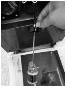
Der Brennstofffilter befindet sich im Heizgerätbehälter.
