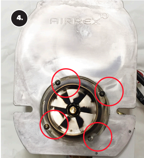
Avaa suuttimen suojaPELLIN ruuvit (4 kpl).
